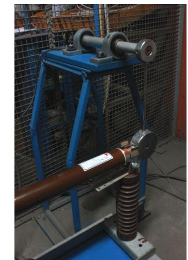
Pim enerjisinin ölçüldüğü sarkaç deneyi makinası
